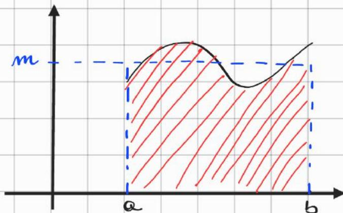
Graficamente  $m$  è l'altezza di un rettangolo di base  $b-a$ , con la stessa area del sottografico di  $f$ .
